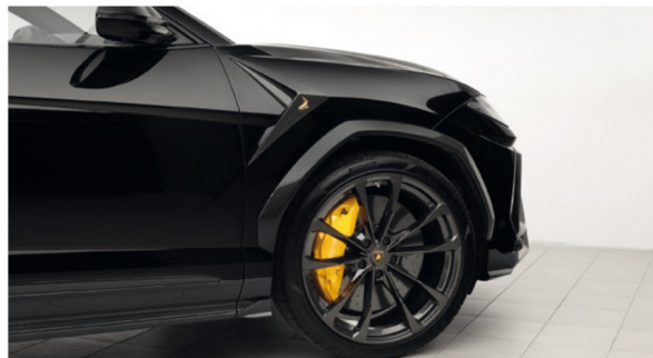
Selbst die 23-Zöller wirken in den Urus-Radkästen nicht wirklich groß. Die Carbon-Keramik-Bremsscheiben messen vorne 440 Millimeter!
